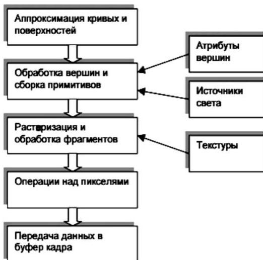
Рис. 2. Производительность конвейера OpenGL
