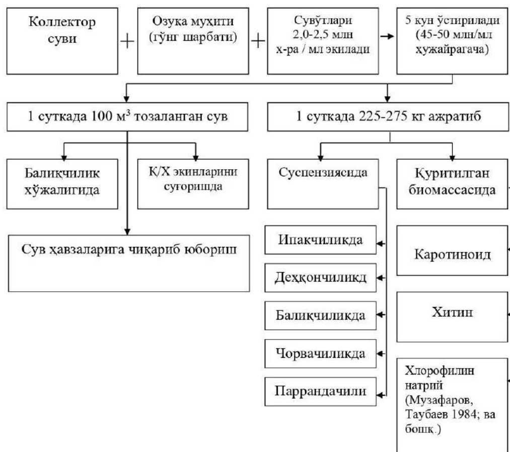
1-расм. Бухоро вилояти коллекторларидан ажратиб олинган Ch. pyrenoidosa ва S. obliquus ёрдамида тозаланган коллектор сувларининг ва унда етиштирилган сувўтлари биомассаларининг халқ хўжалигида ишлатилиш схемаси
